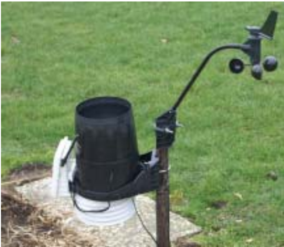
Abb. 6: Davis-Sensoreinheit Regen, Temperatur, Luftfeuchte, Wind.
